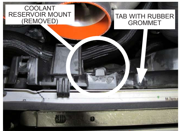
Fig. 1-ab: Modify Fan Shroud
