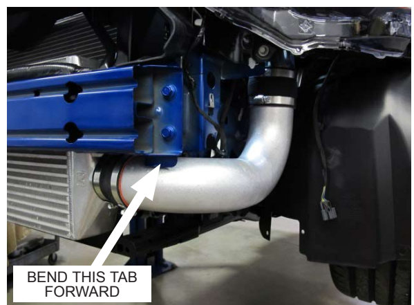
Fig. 4-am: Install Discharge Tube C
