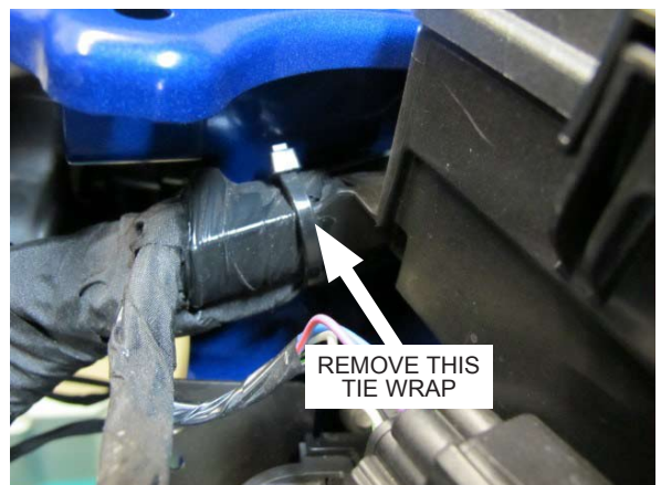
Fig. 4-i: Remove Harness Tie Wrap
