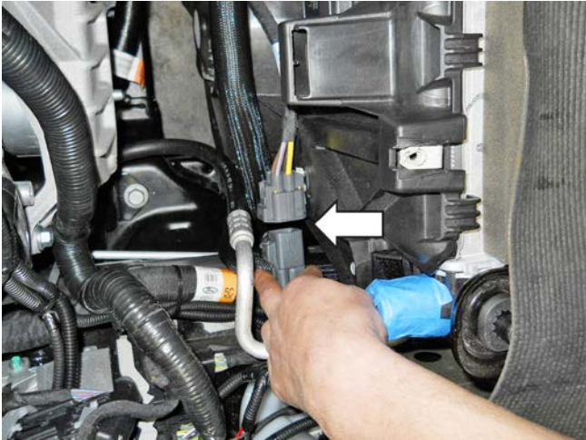
Fan electrical connector
