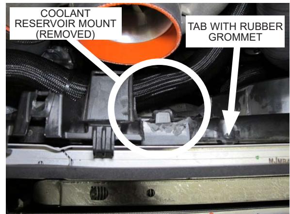
Fig. 1-ab: Modify Fan Shroud
