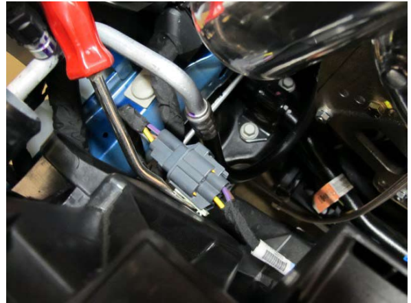
Fig. 4-m: Detach Cooling Fan Connector From Fan Shroud
