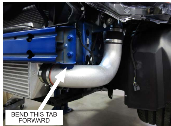
Fig. 4-am: Install Discharge Tube C
