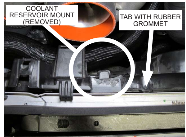
Fig. 1-ab: Modify Fan Shroud
