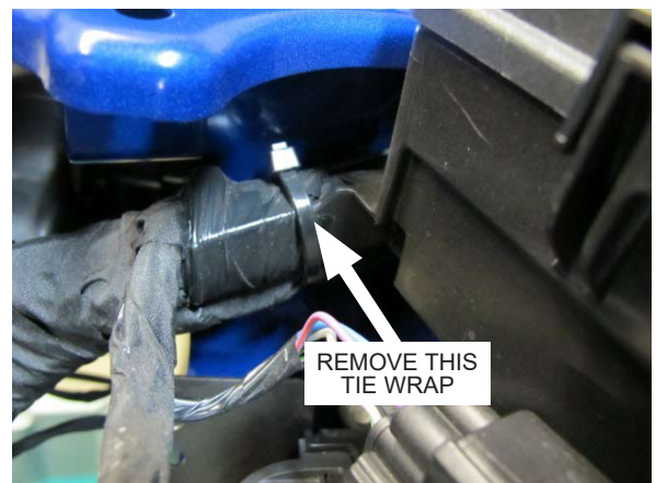
Fig. 4-i: Remove Harness Tie Wrap
