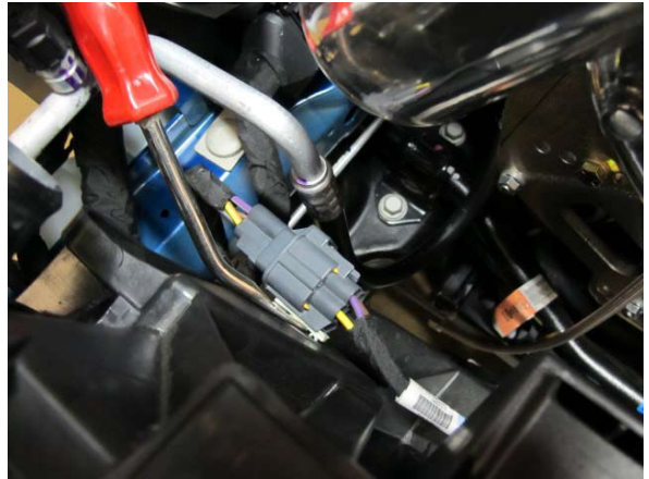
Fig. 4-m: Detach Cooling Fan Connector From Fan Shroud
